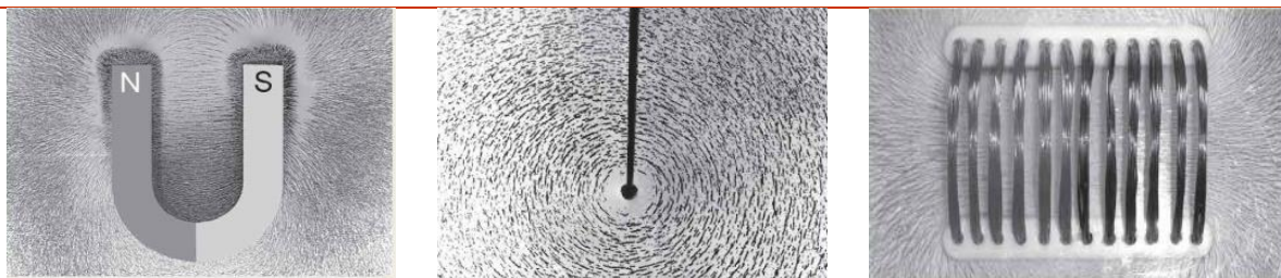
Hình ảnh các mạt sắt phân bố xung quanh nam châm hình chữ U
